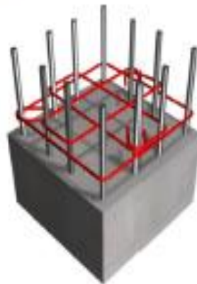
شكل يوضح قطاع العمود و توزيع أسياخ التسليح داخله
